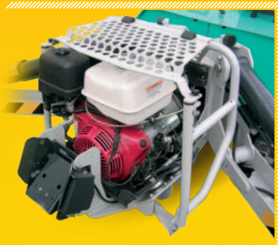
La struttura protettiva del motore garantisce protezione dagli urti ed elevata accessibilità.
