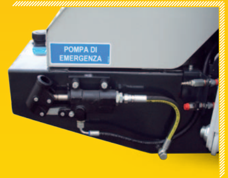
Pompa di emergenza manuale di facile accesso ed operatività.
