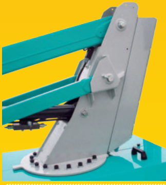
La torretta di rotazione racchiude i componenti.
