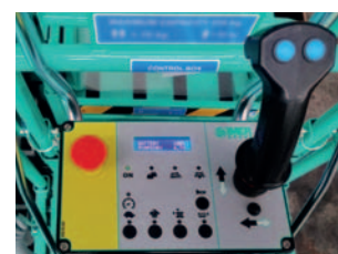
Quadro comandi sulla piattaforma con pulsanti capacitivi: semplicità e sicurezza di utilizzo
