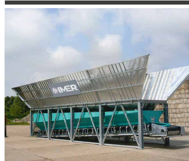
Gruppo di stoccaggio logik WL4 in fase di montaggio
