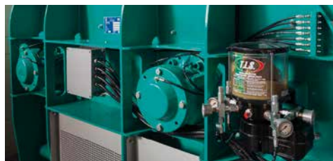
Sistema di ingrassaggio automatico dotato di 4 pompe programmabili e indipendenti
