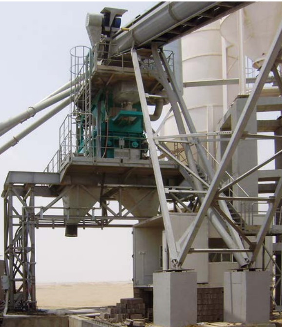
Gruppo di miscelazione ORU LK 150TDB con ampio portale per il carico di più autobetoniere in contemporanea grazie a sistema con BYPASS
