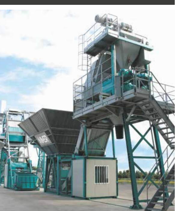
Impianto di betonaggio ORU ONEDAY con stoccaggio, cabina e skip pesatore incorporato
