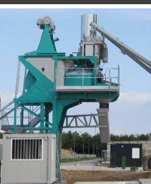
Gruppo di miscelazione ORUMULTIS con skip e cabina incorporati anche durante le fasi di trasporto
