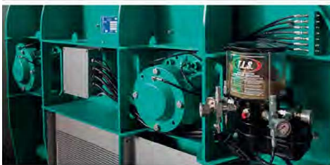
Sistema di ingrassaggio automatico dotato di 4 pompanti programmabili e indipendenti
