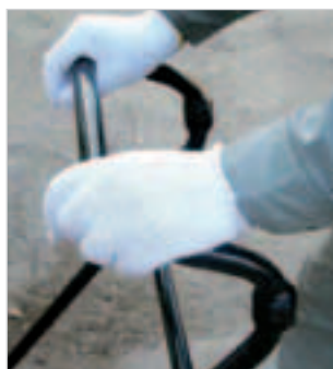
Impugnatura con dispositivo VAS
