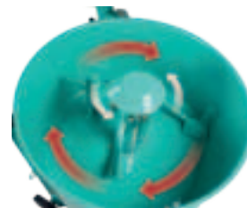
Sistema di inversione del senso di rotazione delle pale. Permette di disintegrare eventuali grumi e di riprendere la mescolazione normale senza interventi manuali diretti.
