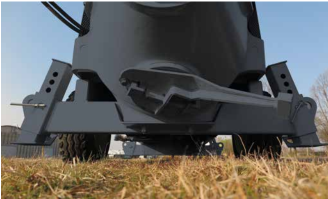
Sportello di scarico per pulizia ottimale della tramoggia.
