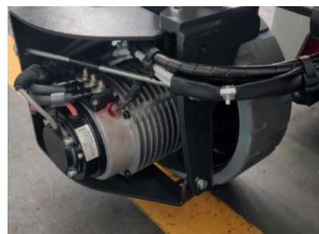
Motore elettrico AC. Sterzo idraulico a 90°
