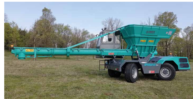
Massima manovrabilità grazie allo sterzo attivo su tutte e quattro le ruote motrici
