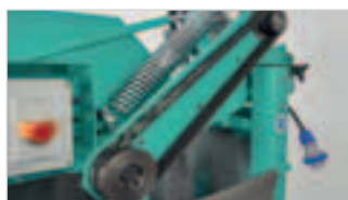
Getriebe mit drei gezahnten Trapezriemen und Keilscheiben.
