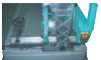
In den Griff integrierte AUS-Taste
