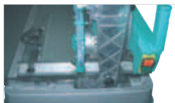
In den Griff integrierte AUS-Taste
