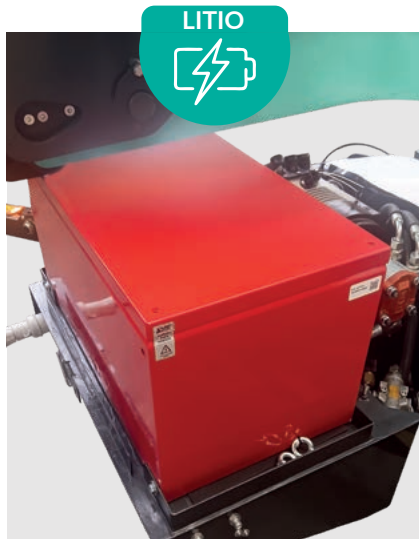
Vano batterie Litio (allestimento Litio).
