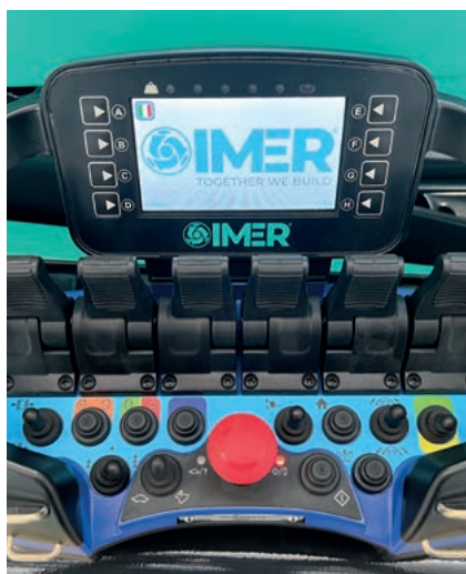
Radiocomando con display integrato da 4,3" ad alta risoluzione.
