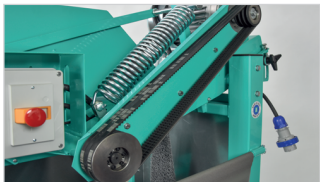
Getriebe mit drei gezahnten Trapezriemen und Keilscheiben.
