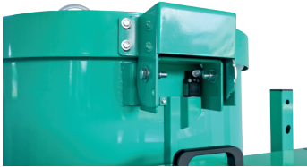
Elektrische Sicherheitsvorrichtung, die die Drehung der Mischschaufeln automatisch stoppt, wenn der I-DUST Rost angehoben wird.
