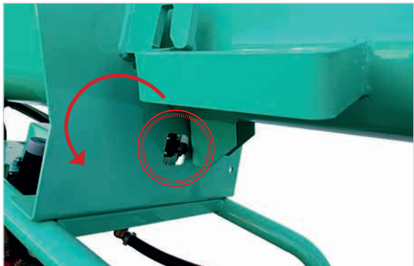
Sicherheitssensor bei geöffneter Mischkammer
