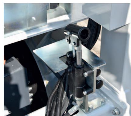
Manuelle Notabsenkung der Stützen
