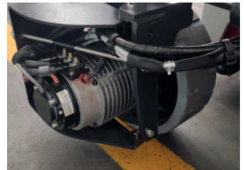
Wechselstrom-Elektromotor (AC). 90° Lenkung.
