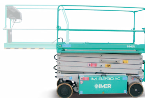
Manuelle Plattformverlängerung um 1,3 m.
