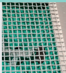
Vibrationsgitter mit durchlass 12 mm.
