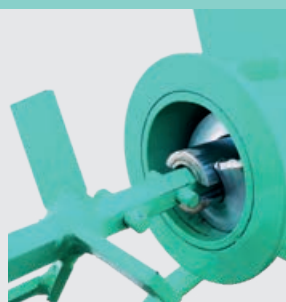
Blashaube mit Filtern zum Anschluss an das Fördersystem (optional).
