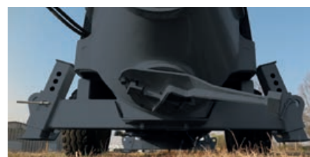
Entladetür des Trichters.
