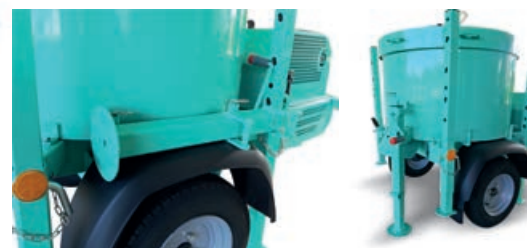
Standardmäßig gelieferter Wagenheber zum Anheben der Maschine.
