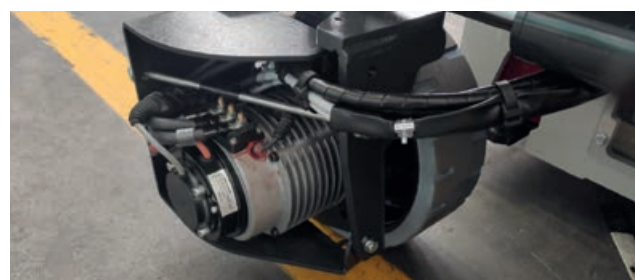
Wechselstrom-Elektroantriebsmotoren an den Vorderrädern.
