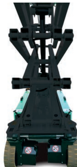
Neues Design des Chassis, das eine einfache Reinigung ermöglicht und den Schutz der Komponenten gewährleistet.
