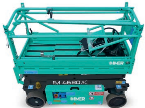
Klappgeländer, einfache Demontage durch Sicherheitssplinte.
