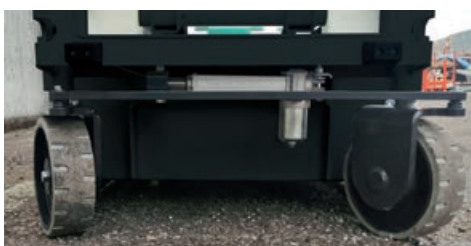
Elektrische Frontlenkung ermöglicht maximale Präzision der Bewegungen.
