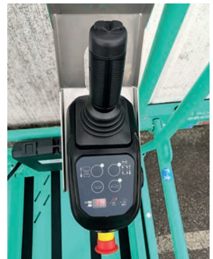
Neues Bedienpult in der Plattform mit Soft-Touch-Technologie. Es kann mit Hilfe des Schutzbügels rund um die Plattform positioniert werden.
