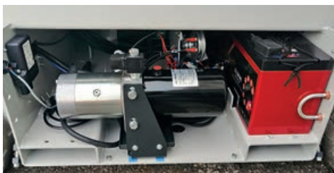
AGM-Batterien zur Erleichterung der Wartung. Neue Anordnung der Hydraulikkomponenten am unteren Rahmen, der Gabelstaplertaschen integriert.
