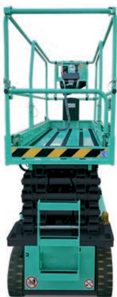
Neues Design der Arbeitsbühnen, Scheren und des selbstverriegelnden Eingangstores.
