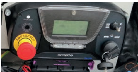
Neues Bodenbedienpult mit integriertem Display für Datenabruf und Fehlersuche.
