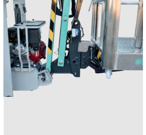
Kompaktheit der Auslegerbaugruppe, in der sich Wägezelle und das Schnellmontagesystem für Korb befindet.
