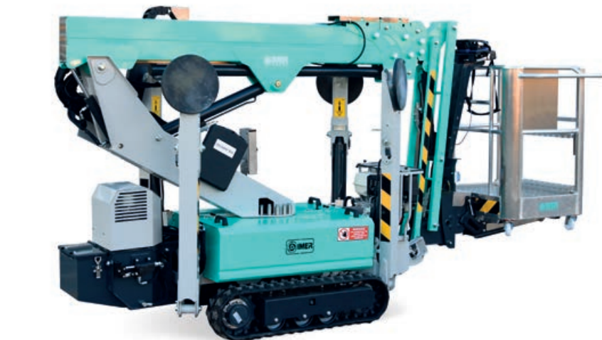
Die kompakte Größe und das reduzierte Gewicht ermöglichen eine einfache Bewegung und Platzierung der Maschine an engen Stellen. Die Raupe kann auch mit Kleinfahrzeugen transportiert werden.
