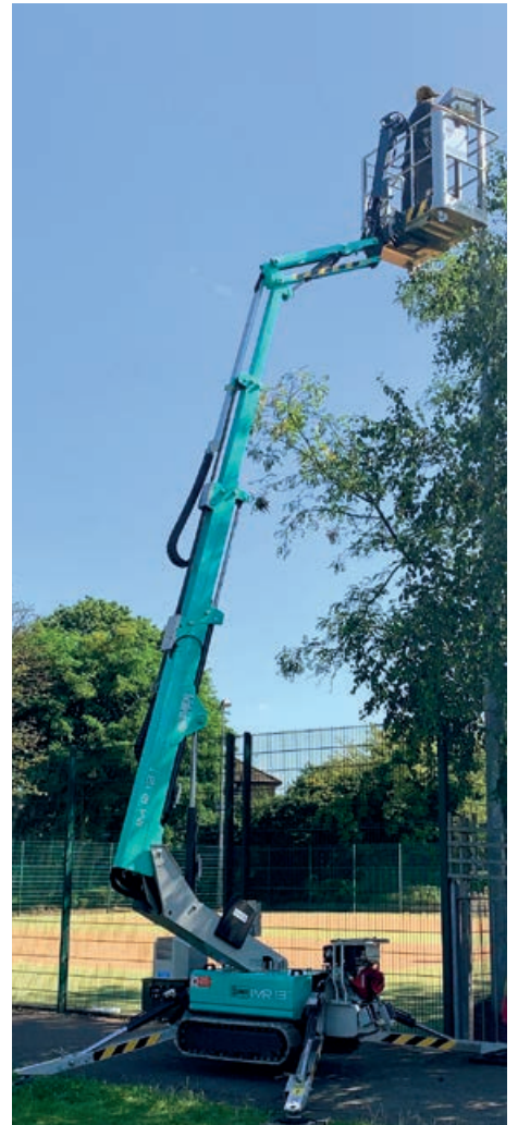
Die automatische Stabilisierung in der Arbeitsposition sorgt für maximalen Bedienkomfort und Sicherheit.
