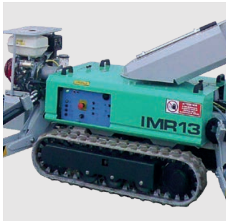
Leicht zugängliches Bodenbedienfeld und geschützte Innenrahmen.
