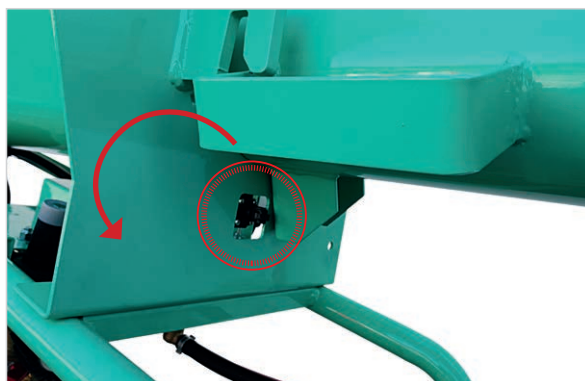
Sensore di sicurezza apertura camera di miscelazione
