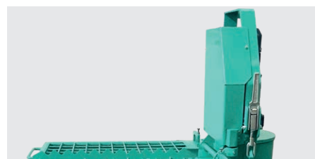
Deviatore di flusso aria di raffreddamento del motore mescolatore, per evitare il diffondersi delle polveri nell'ambiente di lavoro durante il caricamento a sacco.
