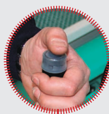
Deviatore di flusso aria di raffreddamento del motore mescolatore, per evitare il diffondersi delle polveri nell'ambiente di lavoro durante il caricamento a sacco.
