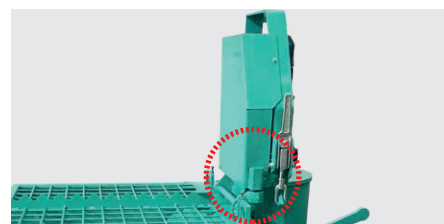
Sensore di sicurezza apertura camera di miscelazione.
