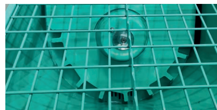
Nuovo disegno della ruota con celle più grandi per migliorare la raccolta di materiali ricchi di fibre.
