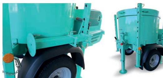
Piede per sollevamento macchina fornito di serie.
